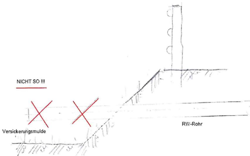
Erhöhter Pflegeaufwand !!! Beschädigung der Rohrausmündung bei Reinigungsarbeiten !!!
