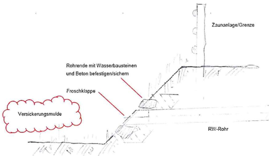
Froschklappen verhindern das Tiere in den Kanal kriechen und Laub und kleine Äste in die Rohrleitung gedrückt werden.
