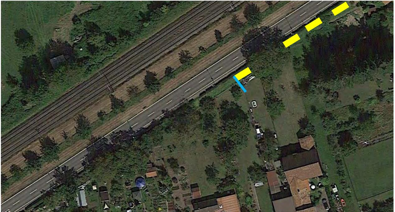
Abb. 2: Lage (gelbe Kästen) der CEF-Maßnahmen (Gabionenkästen) für die Zauneidechse. Genauer Lage der Gabionenkästen mit Sandhinterfüllung ist den Planunterlagen zu entnehmen. Blau = Einwanderungsschutz.
