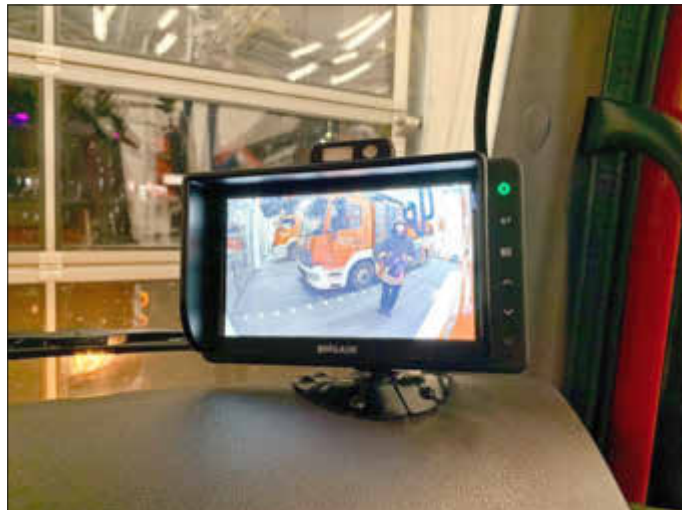
Über diesen Bildschirm in der Fahrerkabine kann der überwachte tote Winkel eingesehen werden.
