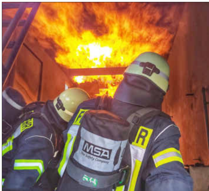
Durchzündung in der gasbefeuelten Brandsimulationsanlage
